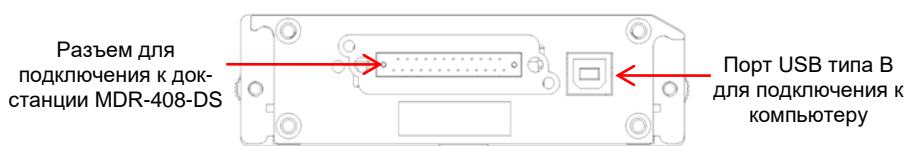
Рисунок 6: Мобильный контейнер с жестким диском MDR-408XX-1000-MCU
