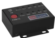
Панель дистанционного управления, индикации статуса и интерфейса первого поколения MDR MDR-RP-01-P
