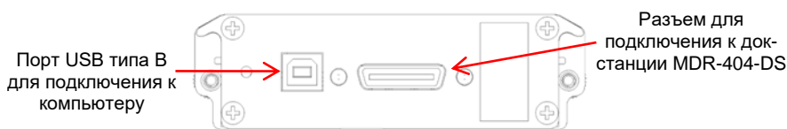
Рисунок 5: Мобильный контейнер с жестким диском MDR-404XX-500-MCU
